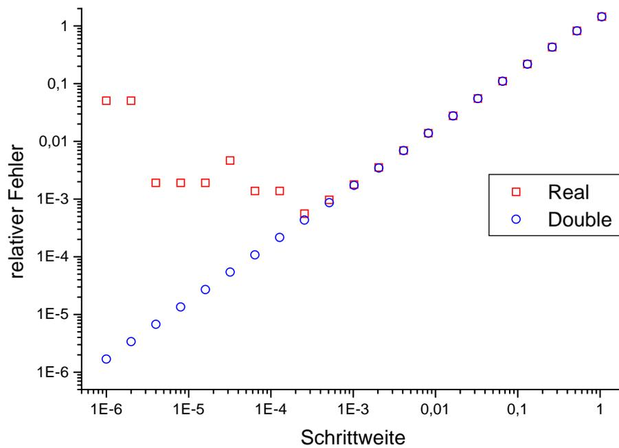
Abb.1: Vergleich des relativen Fehlers in Abhängigkeit der Schrittweite für REAL und DOUBLE PRECISION Variablen.
