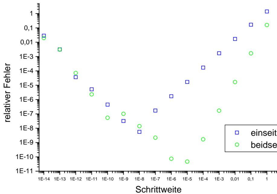
Abb.2: Vergleich des relativen Fehlers in Abhängigkeit der Schrittweite für einseitig und beidseitig numerische Differentiation.
