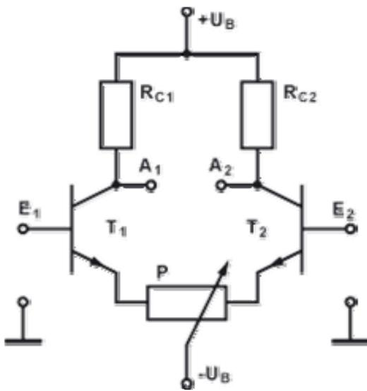
Wir bauten die Schaltung gemäß Schaltbild, jedoch mit einer Abwandlung: unser Verschiebewiderstand wurde nur an den Emitter1 angehängt und der Emitter2 wurde mit Emitter1 verbunden. Anschließend maßen wir die Gegentakt- und die Gleichtaktverstärkung.
